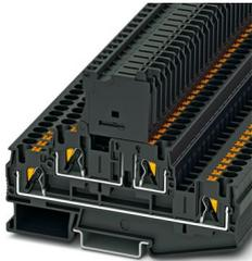
Sicherungsreihenklemme, Art der Sicherung: Glas / Keramik / ..., Sicherungstyp: G / 5 x 20, Nennspannung: 500 V, Nennstrom: 28 A, Anschlussart: Push-in-Anschluss, 1. Etage, Bemessungsquerschnitt: 4 mm<sup>2</sup>, Querschnitt: 0,2 mm<sup>2</sup>- 6 mm<sup>2</sup>, Anschlussart: Push-in-Anschluss, 2. Etage, Bemessungsquerschnitt: 4 mm<sup>2</sup>, Querschnitt: 0,2 mm<sup>2</sup>- 6 mm<sup>2</sup>, Montageart: NS 35/7,5, NS 35/15, Farbe: schwarz
