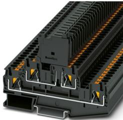
Sicherungsreihenklemme, Art der Sicherung: Glas / Keramik / ..., Sicherungstyp: G / 5 x 20, Nennspannung: 500 V, Nennstrom: 28 A, Anschlussart: Push-in-Anschluss, 1. Etage, Bemessungsquerschnitt: 4 mm<sup>2</sup>, Querschnitt: 0,2 mm<sup>2</sup>- 6 mm<sup>2</sup>, Anschlussart: Push-in-Anschluss, 2. Etage, Bemessungsquerschnitt: 4 mm<sup>2</sup>, Querschnitt: 0,2 mm<sup>2</sup>- 6 mm<sup>2</sup>, Montageart: NS 35/7,5, NS 35/15, Farbe: schwarz
