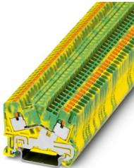
Schutzleiter-Reihenklemme, Anzahl der Anschlüsse: 2, Anschlussart: Push-in-Anschluss, 1. Etage, Querschnitt: 0,14 mm<sup>2</sup> - 4 mm<sup>2</sup>, Montageart: NS 35/7,5, NS 35/15, Farbe: grün-gelb
