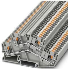
Doppelstockklemme, Nennspannung: 800 V, Nennstrom: 28 A, Anschlussart: Push-in-Anschluss, 1. und 2. Etage, Bemessungsquerschnitt: 4 mm<sup>2</sup>, Querschnitt: 0,2 mm<sup>2</sup> - 6 mm<sup>2</sup>, Montageart: NS 35/7,5, NS 35/15, Farbe: grau
