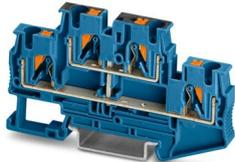
Doppelstockklemme, mit Potenzialverbinder, Nennspannung: 500 V, Nennstrom: 30 A, Anschlussart: Push-in-Anschluss, 1. und 2. Etage, Bemessungsquerschnitt: 4 mm<sup>2</sup>, Querschnitt: 0,2 mm<sup>2</sup> - 6 mm<sup>2</sup>, Montageart: NS 35/7,5, NS 35/15, Farbe: blau
