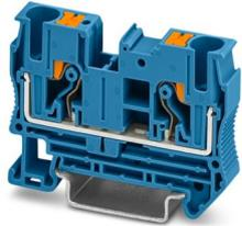
Durchgangsklemme, Nennspannung: 1000 V, Nennstrom: 41 A, Anzahl der Anschlüsse: 2, Polzahl: 1, Anschlussart: Push-in-Anschluss, Bemessungsquerschnitt: 6 mm<sup>2</sup>, Querschnitt: 0,5 mm<sup>2</sup> - 10 mm<sup>2</sup>, Montageart: NS 35/7,5, NS 35/15, Farbe: blau
