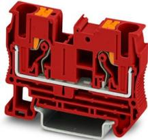
Durchgangsklemme, Nennspannung: 1000 V, Nennstrom: 41 A, Anzahl der Anschlüsse: 2, Anschlussart: Push-in-Anschluss, Bemessungsquerschnitt: 6 mm<sup>2</sup>, Querschnitt: 0,5 mm<sup>2</sup> - 10 mm<sup>2</sup>, Montageart: NS 35/7,5, NS 35/15, Farbe: rot
