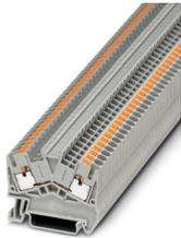
Durchgangsklemme, Nennspannung: 800 V, Nennstrom: 24 A, Anzahl der Anschlüsse: 2, Anschlussart: Push-in-Anschluss, Bemessungsquerschnitt: 2,5 mm<sup>2</sup>, 1. Etage, Querschnitt: 0,14 mm<sup>2</sup> - 4 mm<sup>2</sup>, Montageart: NS 35/7,5, NS 35/15, Farbe: grau
