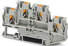
Doppelstockklemme, Nennspannung: 500 V, Nennstrom: 28 A, Anschlussart: Push-in-Anschluss, 1. und 2. Etage, Bemessungsquerschnitt: 4 mm<sup>2</sup>, Querschnitt: 0,2 mm<sup>2</sup> - 6 mm<sup>2</sup>, Montageart: NS 35/7,5, NS 35/15, Farbe: weiß
