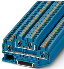
Doppelstockklemme, Nennspannung: 500 V, Nennstrom: 28 A, Anschlussart: Push-in-Anschluss, 1. und 2. Etage, Bemessungsquerschnitt: 4 mm<sup>2</sup>, Querschnitt: 0,2 mm<sup>2</sup> - 6 mm<sup>2</sup>, Montageart: NS 35/7,5, NS 35/15, Farbe: blau
