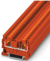
Durchgangsklemme, Nennspannung: 800 V, Nennstrom: 32 A, Anzahl der Anschlüsse: 2, Anschlussart: Push-in-Anschluss, Bemessungsquerschnitt: 4 mm<sup>2</sup>, Querschnitt: 0,2 mm<sup>2</sup> - 6 mm<sup>2</sup>, Montageart: NS 35/7,5, NS 35/15, Farbe: rot
