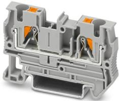
Durchgangsklemme, Nennspannung: 800 V, Nennstrom: 32 A, Anzahl der Anschlüsse: 2, Anschlussart: Push-in-Anschluss, Bemessungsquerschnitt: 4 mm<sup>2</sup>, Querschnitt: 0,2 mm<sup>2</sup> - 6 mm<sup>2</sup>, Montageart: NS 35/7,5, NS 35/15, Farbe: grau
