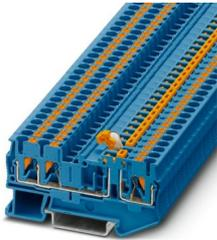
Messertrennklemme, Nennspannung: 400 V, Nennstrom: 20 A, Anschlussart: Push-in-Anschluss, Bemessungsquerschnitt: 2,5 mm<sup>2</sup>, Querschnitt: 0,14 mm<sup>2</sup> - 4 mm<sup>2</sup>, Montage: NS 35/7,5, NS 35/15, Farbe: blau
