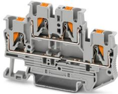
Bauelementreihenklemme, zum Einbau von selbst wählbaren Bauelementen, Nennspannung: 500 V, Nennstrom: 22 A, Anschlussart: Push-in-Anschluss, Bemessungsquerschnitt: 2,5 mm<sup>2</sup>, Querschnitt: 0,14 mm<sup>2</sup> - 4 mm<sup>2</sup>, Montageart: NS 35/7,5, NS 35/15, Farbe: grau
