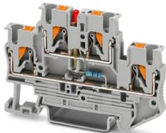
Doppelstockklemme, Die Betriebsspannung wird durch die Leuchtanzeige-Variante bestimmt. Kenndaten LED 30 V DC ... 60 V DC, 0,8 mA ... 1,8 mA, Nennspannung: 500 V, Nennstrom: 20 A, 1. und 2. Etage, Anschlussart: Push-in-Anschluss, Bemessungsquerschnitt: 2,5 mm<sup>2</sup>, Querschnitt: 0,14 mm<sup>2</sup> - 4 mm<sup>2</sup>, Montage: NS 35/7,5, NS 35/15, Farbe: grau
