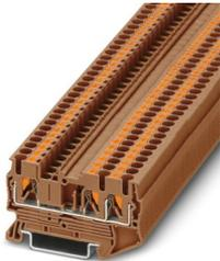
Durchgangsklemme, Nennspannung: 800 V, Nennstrom: 24 A, Anzahl der Anschlüsse: 3, Anschlussart: Push-in-Anschluss, Bemessungsquerschnitt: 2,5 mm<sup>2</sup>, Querschnitt: 0,14 mm<sup>2</sup> - 4 mm<sup>2</sup>, Montageart: NS 35/7,5, NS 35/15, Farbe: braun
