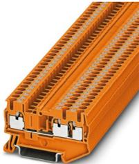
Durchgangsklemme, Nennspannung: 800 V, Nennstrom: 24 A, Anzahl der Anschlüsse: 3, Anschlussart: Push-in-Anschluss, Bemessungsquerschnitt: 2,5 mm<sup>2</sup>, Querschnitt: 0,14 mm<sup>2</sup> - 4 mm<sup>2</sup>, Montageart: NS 35/7,5, NS 35/15, Farbe: orange
