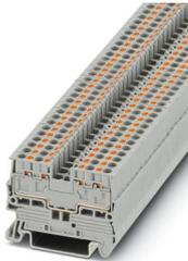
Durchgangsklemme, mit verbreiterten Markierungsnuten für TMT... Materialien, Nennspannung: 500 V, Nennstrom: 17,5 A, Anzahl der Anschlüsse: 4, Anschlussart: Push-in-Anschluss, Bemessungsquerschnitt: 2,5 mm<sup>2</sup>, 1. Etage, Querschnitt: 0,14 mm<sup>2</sup> - 2,5 mm<sup>2</sup>, Montageart: NS 35/7,5, NS 35/15, Farbe: grau
