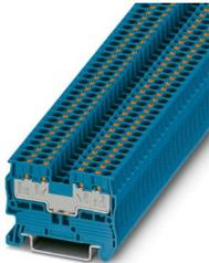
Durchgangsklemme, Nennspannung: 500 V, Nennstrom: 17,5 A, Anzahl der Anschlüsse: 4, Anschlussart: Push-in-Anschluss, Bemessungsquerschnitt: 2,5 mm<sup>2</sup>, Querschnitt: 0,14 mm<sup>2</sup> - 4 mm<sup>2</sup>, Montageart: NS 35/7,5, NS 35/15, Farbe: blau
