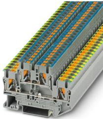
Schutzleiter-Doppelstockklemme, Nennspannung: 500 V, Nennstrom: 24 A, Anschlussart: Push-in-Anschluss, 1. und 2. Etage, Bemessungsquerschnitt: 2,5 mm<sup>2</sup>, Querschnitt: 0,14 mm<sup>2</sup> - 4 mm<sup>2</sup>, Montageart: NS 35/7,5, NS 35/15, Farbe: grau
