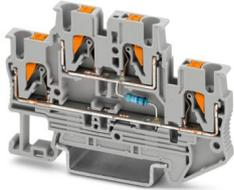
Bauelementreihenklemme, 1. und 2. Etage, Anschlussart: Push-in-Anschluss, Bemessungsquerschnitt: 2,5 mm<sup>2</sup>, Querschnitt: 0,14 mm<sup>2</sup> - 4 mm<sup>2</sup>, Montage: NS 35/7,5, NS 35/15, Farbe: grau
