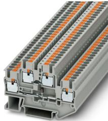
Bauelementreihenklemme, mit integrierter Diode 1N4007, Nennstrom: 0,5 A, Anzahl der Anschlüsse: 4, Anschlussart: Push-in-Anschluss, Bemessungsquerschnitt: 2,5 mm<sup>2</sup>, 1. und 2. Etage, Querschnitt: 0,14 mm<sup>2</sup> - 4 mm<sup>2</sup>, Montageart: NS 35/7,5, NS 35/15, Farbe: grau
