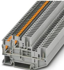
Doppelstockklemme, Strom und Spannung werden durch den eingesetzten Stecker bestimmt., mit Potenzialverbinder, Nennspannung: 500 V, Nennstrom: 22 A, Anschlussart: Push-in- / Steckanschluss, 1. und 2. Etage, Bemessungsquerschnitt: 2,5 mm<sup>2</sup>, Querschnitt: 0,14 mm<sup>2</sup> - 4 mm<sup>2</sup>, Montageart: NS 35/7,5, NS 35/15, Farbe: grau
