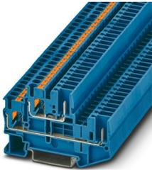
Doppelstockklemme, Strom und Spannung werden durch den eingesetzten Stecker bestimmt., Nennspannung: 500 V, Nennstrom: 22 A, Anschlussart: Push-in- / Steckanschluss, 1. und 2. Etage, Bemessungsquerschnitt: 2,5 mm<sup>2</sup>, Querschnitt: 0,14 mm<sup>2</sup> - 4 mm<sup>2</sup>, Montageart: NS 35/7,5, NS 35/15, Farbe: blau
