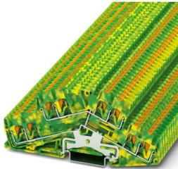
Doppelstockklemme, Anzahl der Anschlüsse: 8, Anschlussart: Push-in-Anschluss, 1. und 2. Etage, Bemessungsquerschnitt: 2,5 mm<sup>2</sup>, Querschnitt: 0,14 mm<sup>2</sup> - 4 mm<sup>2</sup>, Montageart: NS 35/7,5, NS 35/15, Farbe: grün-gelb
