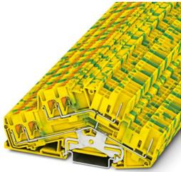
Schutzleiter-Doppelstockklemme, Anzahl der Anschlüsse: 6, Anschlussart: Push-in- / Steckanschluss, 1. und 2. Etage, Bemessungsquerschnitt: 2,5 mm<sup>2</sup>, Querschnitt: 0,14 mm<sup>2</sup> - 4 mm<sup>2</sup>, Montageart: NS 35/7,5, NS 35/15, Farbe: grün-gelb
