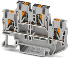
Doppelstockklemme, mit Potenzialverbinder, Nennspannung: 500 V, Nennstrom: 22 A, Anschlussart: Push-in-Anschluss, 1. und 2. Etage, Bemessungsquerschnitt: 2,5 mm<sup>2</sup>, Querschnitt: 0,14 mm<sup>2</sup> - 4 mm<sup>2</sup>, Montageart: NS 35/7,5, NS 35/15, Farbe: grau
