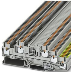
Installations-Schutzleiterklemme, Nennspannung: 400 V, Nennstrom: 20 A, Push-in-Anschluss, Bemessungsquerschnitt: 2,5 mm<sup>2</sup>, Querschnitt: 0,14 mm<sup>2</sup> - 4 mm<sup>2</sup>, Push-in-Anschluss, Bemessungsquerschnitt: 2,5 mm<sup>2</sup>, Querschnitt: 0,14 mm<sup>2</sup> - 4 mm<sup>2</sup>, Montageart: NS 35/7,5, NS 35/15, Farbe: grau
