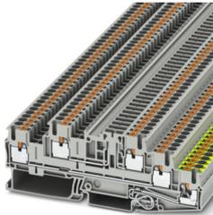
Installations-Schutzleiterklemme, Strom und Spannung werden durch den eingesetzten Stecker bestimmt., Nennspannung: 400 V, Nennstrom: 22 A, Push-in-Anschluss, Bemessungsquerschnitt: 2,5 mm<sup>2</sup>, Querschnitt: 0,14 mm<sup>2</sup> - 4 mm<sup>2</sup>, Push-in-Anschluss, Bemessungsquerschnitt: 2,5 mm<sup>2</sup>, Querschnitt: 0,14 mm<sup>2</sup> - 4 mm<sup>2</sup>, Montageart: NS 35/7,5, NS 35/15, Farbe: grau
