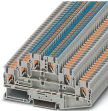
Mehrstockklemme, Nennspannung: 500 V, Nennstrom: 20 A, Anschlussart: Push-in-Anschluss, 1., 2. und 3. Etage, Bemessungsquerschnitt: 2,5 mm<sup>2</sup>, Querschnitt: 0,14 mm<sup>2</sup> - 4 mm<sup>2</sup>, Montageart: NS 35/7,5, NS 35/15, Farbe: grau
