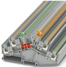
Messertrennklemme, doppelstöckig mit schräger Kontur und zwei Trennmessern, Nennspannung: 400 V, Nennstrom: 16 A, 1. und 2. Etage, Anschlussart: Push-in-Anschluss, Bemessungsquerschnitt: 2,5 mm<sup>2</sup>, Querschnitt: 0,14 mm<sup>2</sup> - 4 mm<sup>2</sup>, Montage: NS 35/7,5, NS 35/15, Farbe: grau
