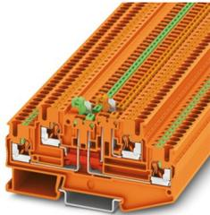
Messertrennklemme, Nennspannung: 400 V, Nennstrom: 16 A, 1. und 2. Etage, Anschlussart: Push-in-Anschluss, Bemessungsquerschnitt: 2,5 mm<sup>2</sup>, Querschnitt: 0,14 mm<sup>2</sup> - 4 mm<sup>2</sup>, Montage: NS 35/7,5, NS 35/15, Farbe: orange
