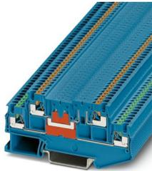
Durchgangsklemme, Nennspannung: 400 V, Nennstrom: 9 A, Anzahl der Anschlüsse: 4, Anschlussart: Push-in-Anschluss, Bemessungsquerschnitt: 1,5 mm<sup>2</sup>, 1. und 2. Etage, Querschnitt: 0,14 mm<sup>2</sup> - 1,5 mm<sup>2</sup>, Montageart: NS 35/7,5, NS 35/15, Farbe: blau
