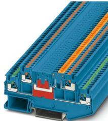
Messertrennklemme, Nennspannung: 400 V, Nennstrom: 9 A, 1. und 2. Etage, Anschlussart: Push-in-Anschluss, Bemessungsquerschnitt: 1,5 mm<sup>2</sup>, Querschnitt: 0,14 mm<sup>2</sup> - 1,5 mm<sup>2</sup>, Montage: NS 35/7,5, NS 35/15, Farbe: blau
