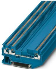
Durchgangsklemme, konturgleich zur Trennklemme, Nennspannung: 400 V, Nennstrom: 17,5 A, Anzahl der Anschlüsse: 3, Anschlussart: Push-in-Anschluss, Bemessungsquerschnitt: 1,5 mm<sup>2</sup>, 1. Etage, Querschnitt: 0,14 mm<sup>2</sup> - 1,5 mm<sup>2</sup>, Montageart: NS 35/7,5, NS 35/15, Farbe: blau
