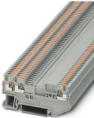
Durchgangsklemme, konturgleich zur Trennklemme, Nennspannung: 400 V, Nennstrom: 17,5 A, Anzahl der Anschlüsse: 3, Anschlussart: Push-in-Anschluss, Bemessungsquerschnitt: 1,5 mm<sup>2</sup>, 1. Etage, Querschnitt: 0,14 mm<sup>2</sup> - 1,5 mm<sup>2</sup>, Montageart: NS 35/7,5, NS 35/15, Farbe: grau
