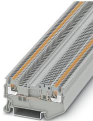
Trennklemme, Strom und Spannung werden durch den eingesetzten Stecker bestimmt., Nennspannung: 400 V, Nennstrom: 10 A, 1. Etage, Anschlussart: Push-in-Anschluss, Bemessungsquerschnitt: 1,5 mm<sup>2</sup>, Querschnitt: 0,14 mm<sup>2</sup> - 1,5 mm<sup>2</sup>, Montage: NS 35/7,5, NS 35/15, Farbe: grau
