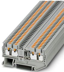
Bauelementreihenklemme, mit integrierter Diode 1N4007, Nennspannung: 800 V, Nennstrom: 0,5 A, Anzahl der Anschlüsse: 4, Anschlussart: Push-in-Anschluss, Bemessungsquerschnitt: 2,5 mm<sup>2</sup>, 1. Etage, Querschnitt: 0,14 mm<sup>2</sup> - 4 mm<sup>2</sup>, Montageart: NS 35/7,5, NS 35/15, Farbe: grau
