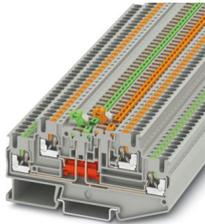
Messertrennklemme, Nennspannung: 400 V, Nennstrom: 16 A, 1. und 2. Etage, Anschlussart: Push-in-Anschluss, Bemessungsquerschnitt: 2,5 mm<sup>2</sup>, Querschnitt: 0,14 mm<sup>2</sup> - 4 mm<sup>2</sup>, Montage: NS 35/7,5, NS 35/15, Farbe: grau
