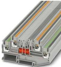
Trennklemme, Strom und Spannung werden durch den eingesetzten Stecker bestimmt., mit Trennstecker, Nennspannung: 400 V, Nennstrom: 16 A, 1. und 2. Etage, Anschlussart: Push-in-Anschluss, Bemessungsquerschnitt: 2,5 mm<sup>2</sup>, Querschnitt: 0,14 mm<sup>2</sup> - 4 mm<sup>2</sup>, Montage: NS 35/7,5, NS 35/15, Farbe: grau
