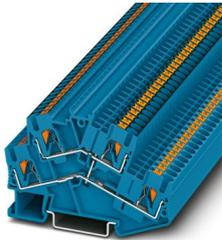
Doppelstockklemme, mit Potenzialverbinder, Nennspannung: 500 V, Nennstrom: 22 A, Anschlussart: Push-in-Anschluss, 1. Etage, Bemessungsquerschnitt: 2,5 mm<sup>2</sup>, Querschnitt: 0,14 mm<sup>2</sup> - 4 mm<sup>2</sup>, Montageart: NS 35/7,5, NS 35/15, Farbe: blau
