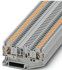
Trennklemme, Strom und Spannung werden durch den eingesetzten Stecker bestimmt., Nennspannung: 400 V, Nennstrom: 16 A, Anschlussart: Push-in-Anschluss, Bemessungsquerschnitt: 2,5 mm<sup>2</sup>, Querschnitt: 0,14 mm<sup>2</sup> - 4 mm<sup>2</sup>, Montage: NS 35/7,5, NS 35/15, Farbe: grau
