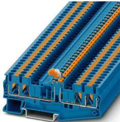
Messertrennklemme, Nennspannung: 400 V, Nennstrom: 16 A, Anschlussart: Push-in-Anschluss, Bemessungsquerschnitt: 2,5 mm<sup>2</sup>, Querschnitt: 0,14 mm<sup>2</sup> - 4 mm<sup>2</sup>, Montage: NS 35/7,5, NS 35/15, Farbe: blau
