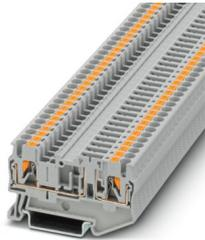
Trennklemme, Strom und Spannung werden durch den eingesetzten Stecker bestimmt., Nennspannung: 400 V, Nennstrom: 20 A, Anschlussart: Push-in-Anschluss, Bemessungsquerschnitt: 2,5 mm<sup>2</sup>, Querschnitt: 0,14 mm<sup>2</sup> - 4 mm<sup>2</sup>, Montage: NS 35/7,5, NS 35/15, Farbe: grau
