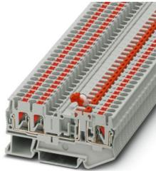
Messertrennklemme, mit rotem Trennmesser und roten Betätigungsdrückern, Nennspannung: 400 V, Nennstrom: 20 A, Anschlussart: Push-in-Anschluss, Bemessungsquerschnitt: 2,5 mm<sup>2</sup>, Querschnitt: 0,14 mm<sup>2</sup> - 4 mm<sup>2</sup>, Montage: NS 35/7,5, NS 35/15, Farbe: grau
