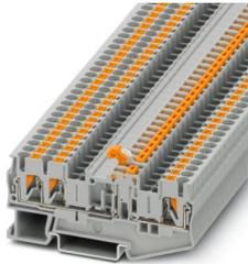
Messertrennklemme, Nennspannung: 400 V, Nennstrom: 16 A, Anschlussart: Push-in-Anschluss, Bemessungsquerschnitt: 2,5 mm<sup>2</sup>, Querschnitt: 0,14 mm<sup>2</sup> - 4 mm<sup>2</sup>, Montage: NS 35/7,5, NS 35/15, Farbe: grau
