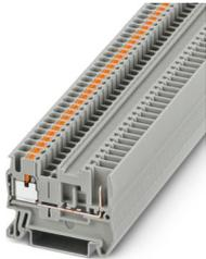
Durchgangsklemme, Nennspannung: 500 V, Nennstrom: 24 A, Anzahl der Anschlüsse: 2, Anschlussart: Push-in- / Steckanschluss, Bemessungsquerschnitt: 2,5 mm<sup>2</sup>, Querschnitt: 0,14 mm<sup>2</sup> - 4 mm<sup>2</sup>, Montageart: NS 35/7,5, NS 35/15, Farbe: grau
