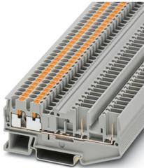
Durchgangsklemme, Nennspannung: 500 V, Nennstrom: 24 A, Anzahl der Anschlüsse: 4, Anschlussart: Push-in- / Steckanschluss, Bemessungsquerschnitt: 2,5 mm<sup>2</sup>, 1. Etage, Querschnitt: 0,14 mm<sup>2</sup> - 4 mm<sup>2</sup>, Montageart: NS 35/7,5, NS 35/15, Farbe: grau
