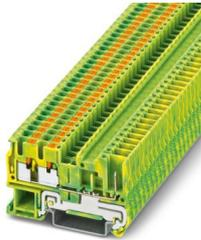
Schutzleiter-Reihenklemme, Anzahl der Anschlüsse: 3, Anschlussart: Push-in- / Steckanschluss, Bemessungsquerschnitt: 2,5 mm<sup>2</sup>, Querschnitt: 0,14 mm<sup>2</sup> - 4 mm<sup>2</sup>, Montageart: NS 35/7,5, NS 35/15, Farbe: grün-gelb
