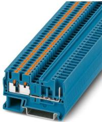
Durchgangsklemme, Nennspannung: 500 V, Nennstrom: 24 A, Anzahl der Anschlüsse: 3, Polzahl: 1, Anschlussart: Push-in- / Steckanschluss, Bemessungsquerschnitt: 2,5 mm<sup>2</sup>, Querschnitt: 0,14 mm<sup>2</sup> - 4 mm<sup>2</sup>, Montageart: NS 35/7,5, NS 35/15, Farbe: blau
